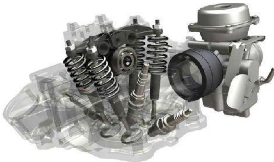
Важай Pulsar NS200 построен на базе двигателя КТМ Duke 200. Оба мотоциклы имеют одинаковый диаметр хода поршня 72 x 49.
